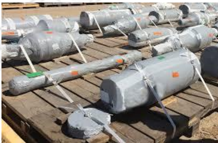
ห่อหุ้มงานด้วยฟิล์มยืดกันสนิม แบบป้องกันแสง UV
