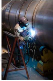
เลือกใช้การเชื่อมแทนการใช้หมุดจากโลหะต่างชนิดที่จะเกิดสนิมได้ง่ายกว่า
