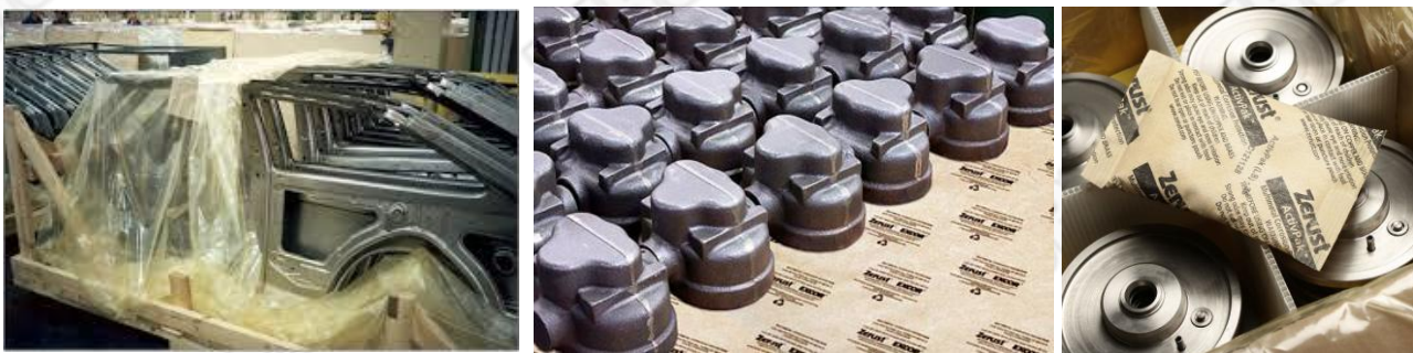
การป้องกันสนิมด้วยหีบห่อหรือซองที่มีสารไอระเหยเพื่อป้องกันสนิม VCI
